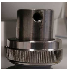
オートサンプラーなしで流路を構築できる金具
