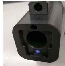
MAS Plus の金属カバーを外したところ
