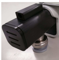
リークチェックツールの取り付けられた MAS Plus
