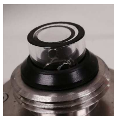
石英管にセットされた上部 O リング(PN29022910)
