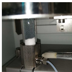
石英管下部金具の接続部 (炉の直下にあります)
