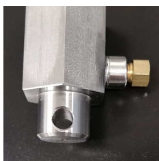
炉体下部金具に取り付けられた 真鍮栓
